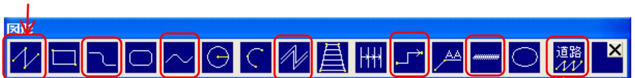
直線と同じように道路線が描けます。作成した平面図を配置するには道路線が必要です。
